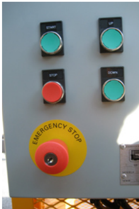
Figure 10-10 Boutons d'arrêt d'urgence sur un équipement mécanique. (a) Ce bouton doit être bien visible et facilement accessible même si un panneau de contrôle doit rester barré. (b) Par mesure de sécurité supplémentaire, certains boutons nécessitent une clé pour être désengagés après un arrêt d'urgence
