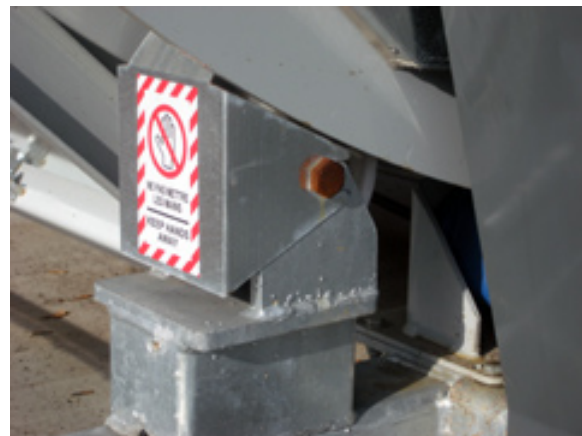
Figure 10-13 Les pièces mobiles telles des roulettes ont avantage à être recouverte pour être moins accessibles
