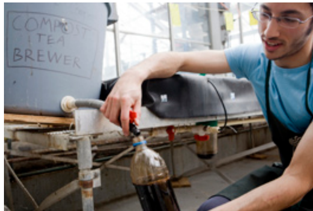
Figure 9-5 Appareil simple pour fabriquer du thé de compost. Le compost mature placé dans une pochette de géotextile est immergé quelques jours dans (a) un contenant d'eau où on injecte de l'air. (b) Le thé est ensuite récolté par un drain au bas du contenant.
