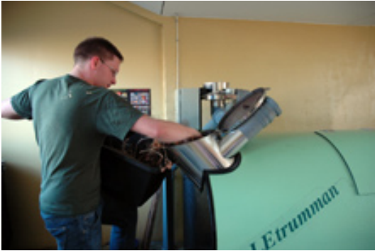
Figure 10-5 (a) Chargement manuel pour un composteur communautaire. (b) Levée mécanique pour charger un composteur institutionnel
