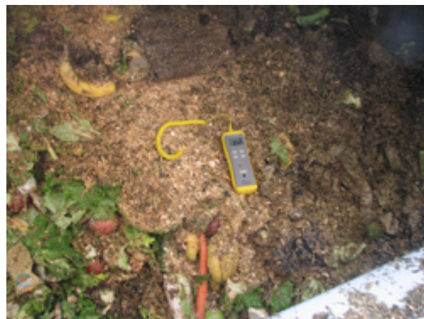
Figure 11-19 Hygromètre, pH mètre et thermomètres peuvent être intégrés dans un seul appareil
