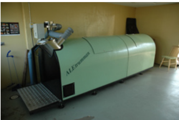
Figure 11-26 (a) Expulsion de l'air d'un composteur directement dans un système d'égouts en Suède.
