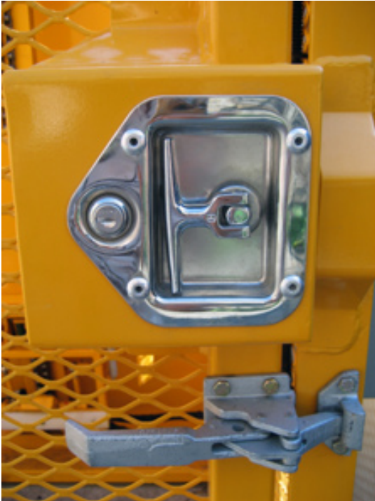
Figure 10-9 Porte de sécurité sur une levée mécanique. La levée mécanique ne peut être opérée si la porte n'est pas fermée
