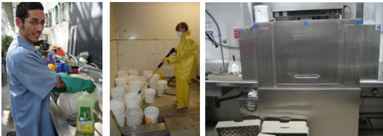
Figure 10-2 Lavage des bacs de collecte (a) manuellement, (b) avec un nettoyeur à pression et (c) dans un lave-vaisselle industriel
