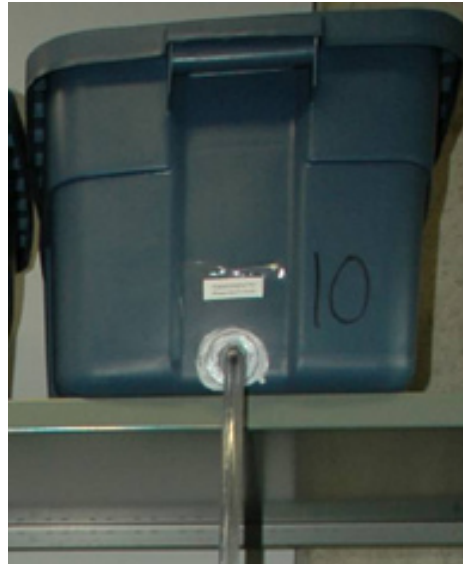
Figure 9-3b (b) Système de collecte de lixiviat et sur un vermicomposteur de type domestique
