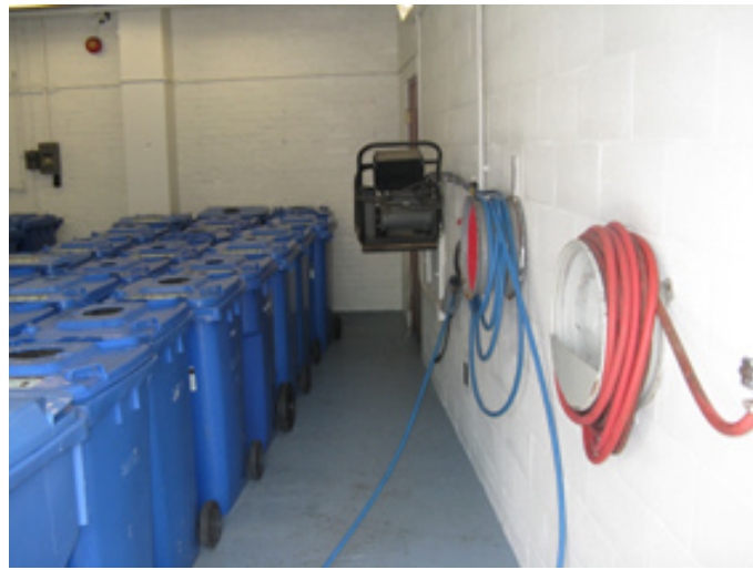
Figure 9-9 Nettoyeur à pression pour laver les bacs. Photo : Jorge Dominguez
