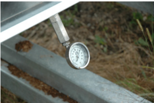
Figure 10-12 Zone de coincement potentielle sur un composteur rotatif entre un thermomètre protubérant et une base fixe
