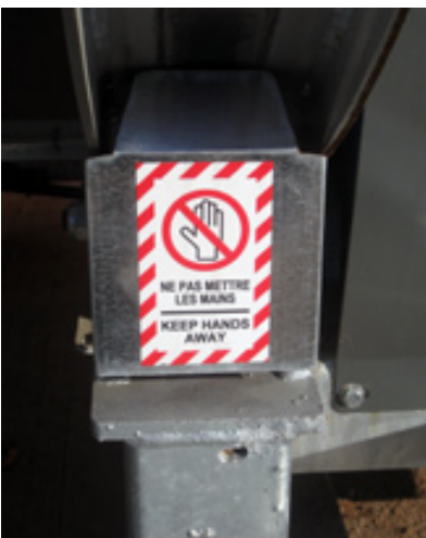
Figure 10-14 Autocollant indiquant à l'opérateur de faire attention à ne pas s'insérer les doigts dans entre des parties mobiles d'un système de compostage
