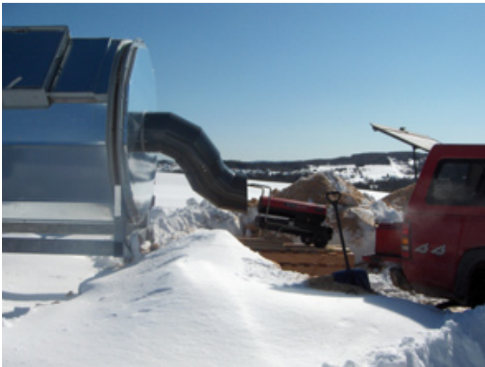
Figure 11-1 Démarrage d'un bio-réacteur en hiver à l'aide de brûleurs pour aider l'initiation du compostage et l'élévation initiale de température. Ensuite, le composteur n'aura plus besoin d'apport calorique supplémentaire
