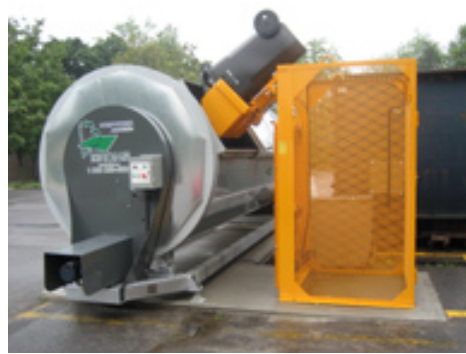
Figure 10-5 (a) Chargement manuel pour un composteur communautaire. (b) Levée mécanique pour charger un composteur institutionnel
