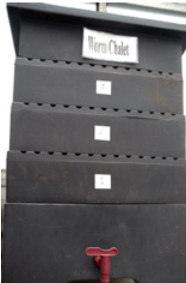
Figure 9-3b (a) Système de collecte de lixiviat sur un vermicomposteur étagé
