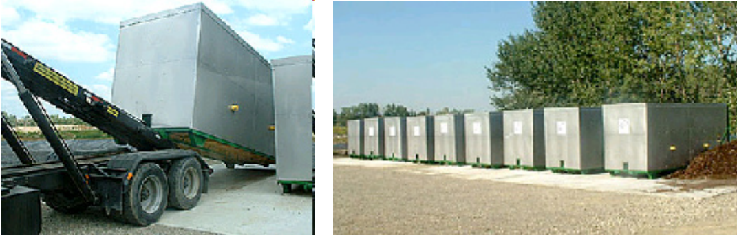
Figure 7-12 Systèmes fermés modulaires statiques en contenant rigides pouvant être raccordé à des unités supplémentaires ou à un système de ventilation
